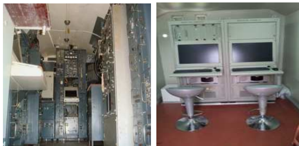
图 7 P-37 雷达电子设备舱升级前后对比实物图
