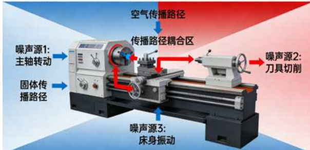
图2 数控车床噪声传播路径示意图
