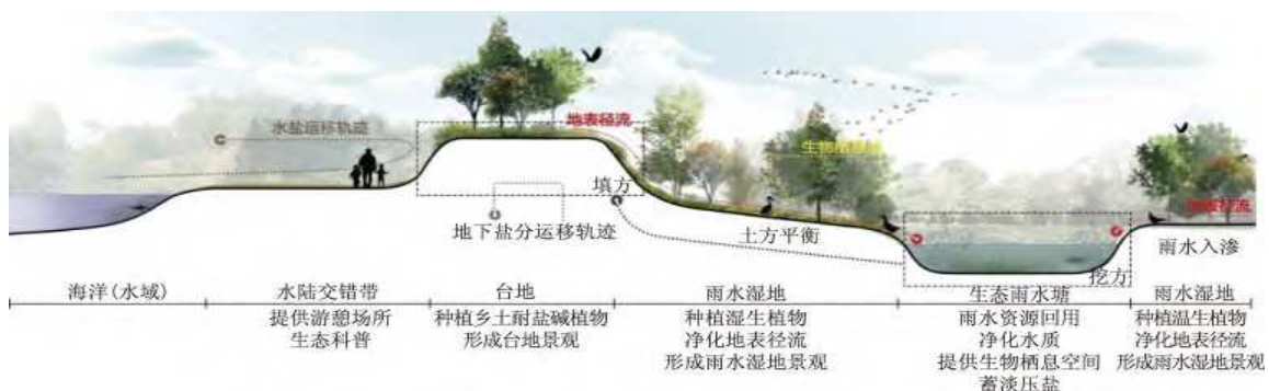
图4 “台地—雨水塘”立体景观模式示意
