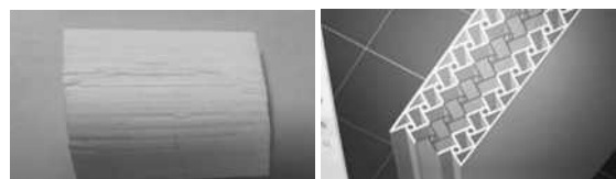
(a) 手性结构破损实物 (b) 手性结构三维切片
