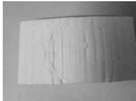
图 8 手性结构破坏实物图
